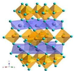
A estrutura cristalina "bipiramidal trigonal" dá ao pimento azul a capacidade para refletir até 40% da radiação infravermelha que incide sobre ele.[Imagem: Oregon State University]
